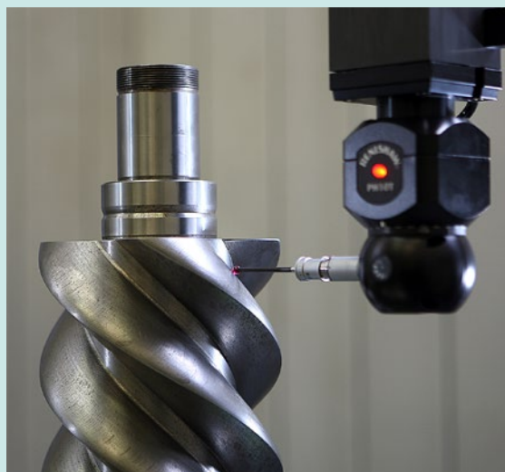
3D měření každého vyrobeného kusu
